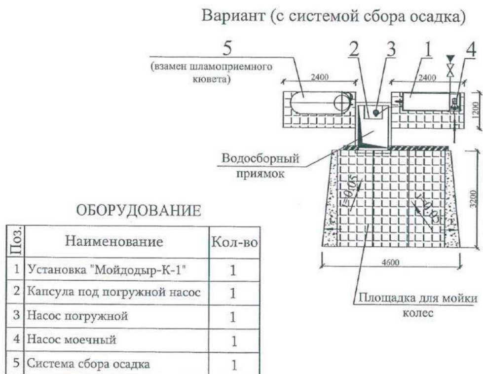
Рис. 2.2.5 - Схема устройства и расположения технологического оборудования комплекта мойки колес «Мойдодыр К-1 (Д)» с системой сбора осадка
