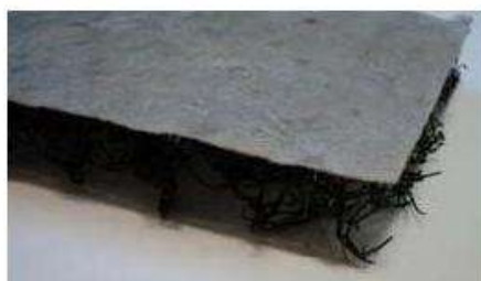
Рис. 6. Мат, скрепленный с двух сторон с геотекстилем
