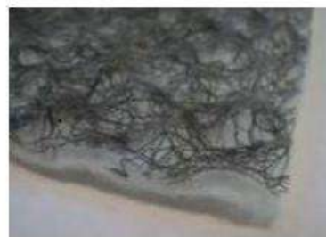
Рис. 7. Мат, скрепленный с одной стороны с геотекстилем
