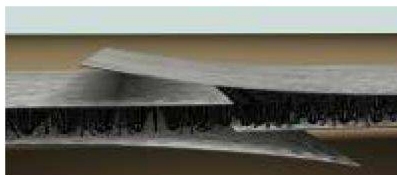
Рис. 38. Стыковка полотен дренажного геокомпозита
