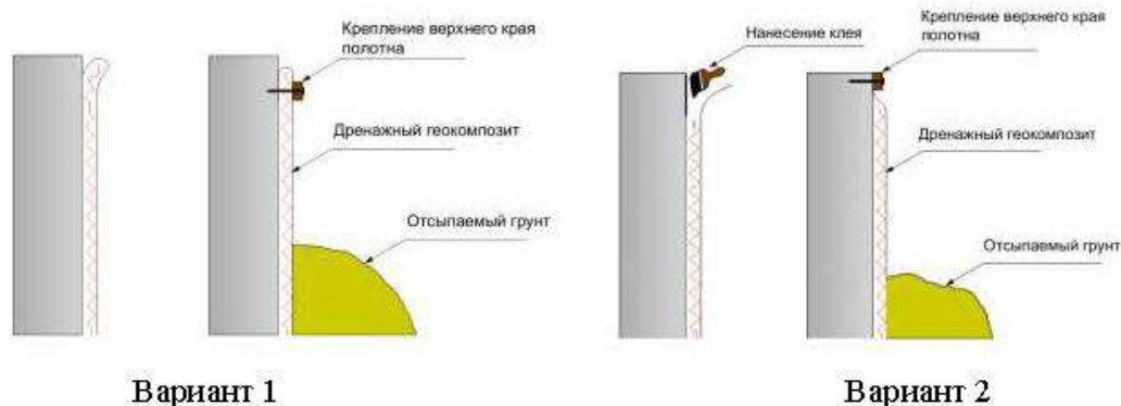
Рис. 43. Крепление дренажного геокомпозита к стене
