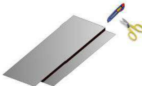
Рис. 37. Нарезка геокомпозита
